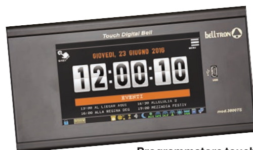
Programmatore touch in sacrestia con radio-comando
