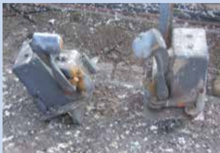
Campanile - rimossi i vecchi martelli per battere le ore
